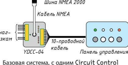
Несколько устройств Circuit Control могут работать синхронно и управляться с нескольких устройств Switch Control с совпадающим номером банка (252 уникальных номера банков доступны в NMEA 2000). Множество независимых систем управления нагрузками (с разными номерами банков) могут сосуществовать в одной сети NMEA 2000.
