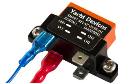
Реле коммутирует две нагрузки одним выключателем. Устройство подключает первый канал нагрузки после включения. Для подключения второго канала необходимо выключить и снова включить выключатель в течение одной секунды.
