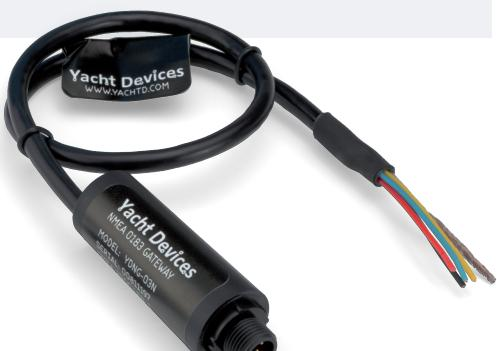
Устройство оборудовано слотом для карт памяти типа MicroSD, который используется для настройки, обновления встроенного ПО и записи диагностических данных. Дополнительное ПО для настройки устройства не требуется, достаточно любого компьютера или мобильного устройства, снабжённого устройством чтения MicroSD карт и текстового редактора.
