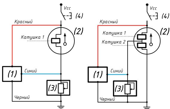
Подключение параллельно с имеющимся однокатушечным (слева) и двухкатушечным (справа) аналоговым прибором: (1) – адаптер, (2) – прибор, (3) – датчик, (4) – кнопка (необязательная)
