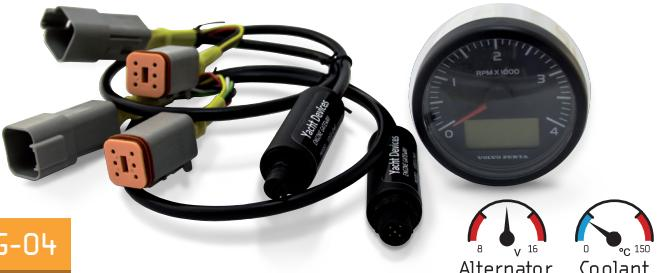
Устройство предназначено для подключения двигателей Volvo Penta, Mercury, Yanmar, BRP Rotax и других, оснащённых цифровой шиной J1939, к сети NMEA 2000. Устройство позволяет получать: число оборотов, моточасы, температуру охлаждающей жидкости и масла, напряжение батареи, предупреждающие и аварийные сигналы, расход топлива и другие параметры для отображения на картплоттере.
