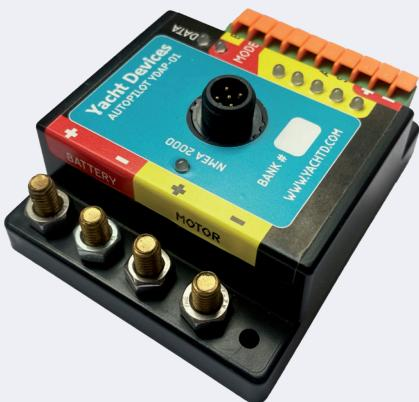
Крошечный модуль автопилота, который может управлять гидравлической помпой или линейным электрическим приводом с рабочим током до 10 А (16 А пиковая нагрузка) и электрическим сцеплением. Чтобы работать в режиме АВТО, требуется только внешний магнитный компас NMEA 2000. Для режимов ВЕТЕР или ТРЕК, требуются также цифровой ветроуказатель или GPS.
