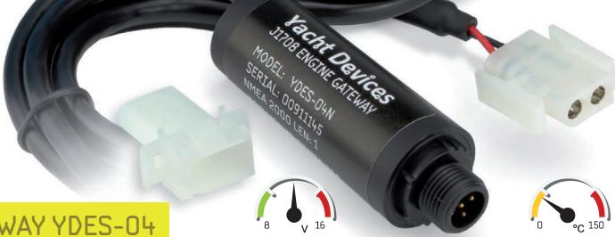
Устройство предназначено для подключения двигателей, оснащенных цифровойшиной J1708, к сети NMEA 2000. Устройство передаёт в сеть NMEA 2000 параметры работы двигателя: число оборотов в минуту, температуру масла и охлаждающей жидкости, наработку по времени, потребление топлива и другие. Данные будут доступны всем навигационным приборам и дисплеям, подключенным к сети NMEA 2000.
