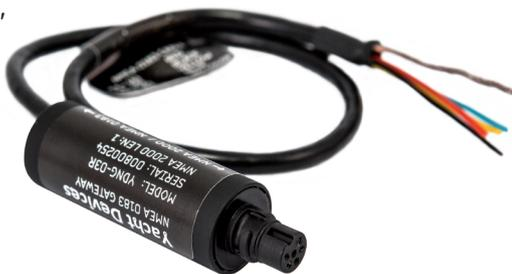
Устройство оборудовано слотом для карты памяти типа MicroSD, который используется для настройки, обновления встроенного ПО и записи диагностических данных. Дополнительное ПО для настройки устройства не требуется, достаточно любого компьютера или мобильного устройства, снабжённого устройством чтения MicroSD карт и текстового редактора.
