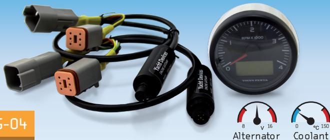
Устройство предназначено для подключения двигателей Volvo Penta, Mercury, Yanmar, BRP Rotax и других, оснащённых цифровой шиной J1939, к сети NMEA 2000. Устройство позволяет получить: число оборотов, моточасы, температуру охлаждающей жидкости и масла, напряжение батареи, предупреждающие и аварийные сигналы, расход топлива и другие параметры для отображения на картплоттере.
